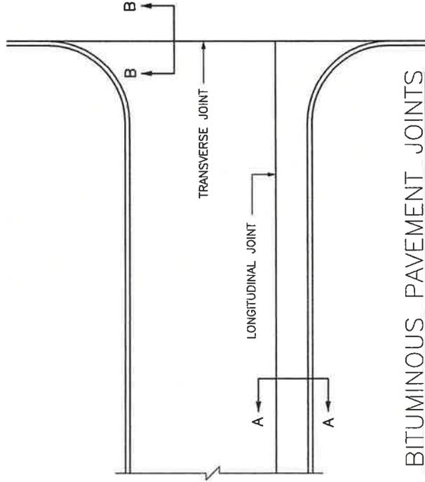
BITUMINOUS PAVEMENT JOINTS
